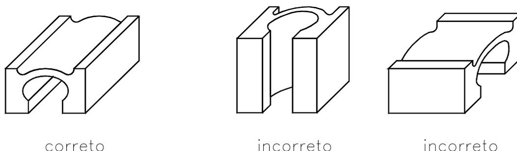
Fig. 3.2: deformação de contornos circulares (uso da regra 1).
