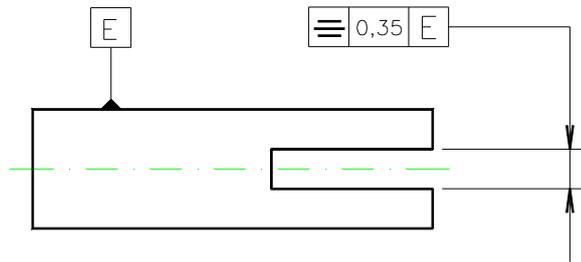
Fig. 17.29: aplicação de tolerância de simetria.
